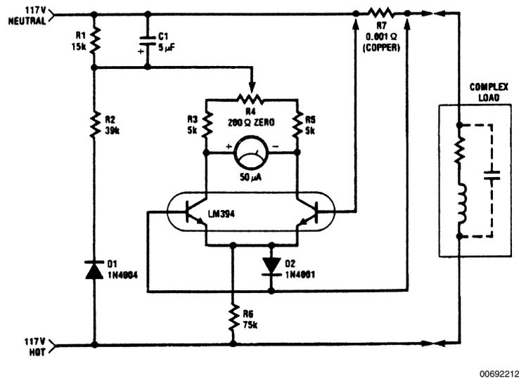
FIGURE 12. Power Meter (1 kW f.s.)
